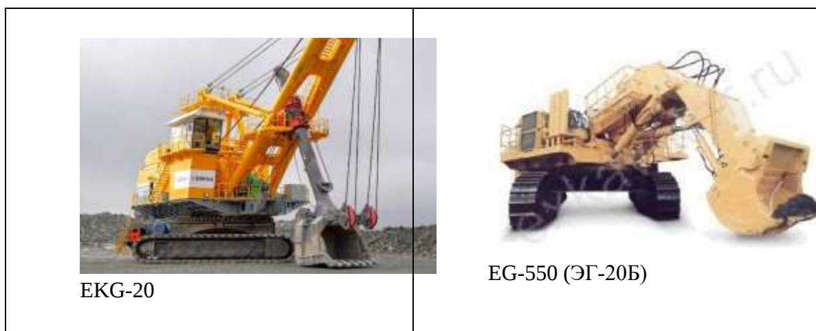
1-rasm. Ochiq konchilik ishlarida qo'llaniladigan ekskavator turlari
