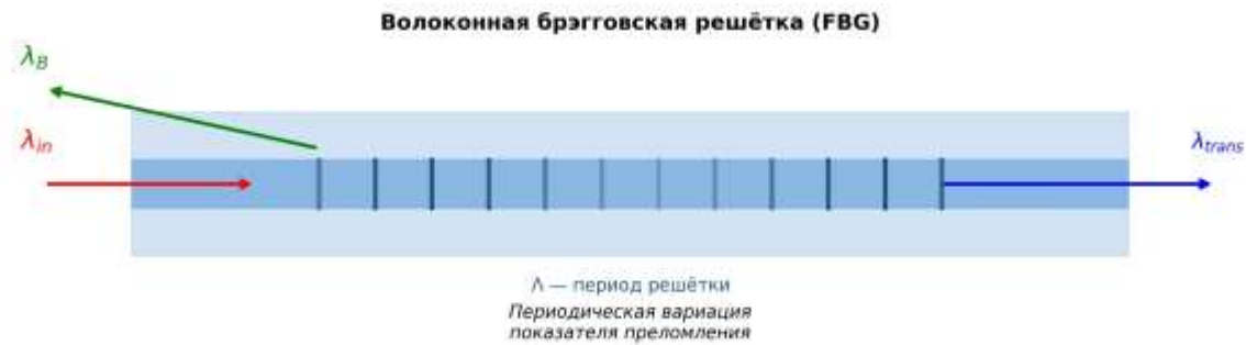
Рис. 1. Схематический вид волоконной брэгговской решётки (FBG). Показаны падающее излучение ( \lambda_{in} ), отражённая брэгговская длина волны ( \lambda_B ) и прошедшее излучение ( \lambda_{trans} )
