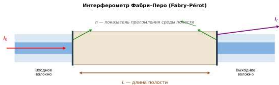
Рис. 2. Схематический вид волоконного интерферометра Фабри-Перо с воздушной полостью
