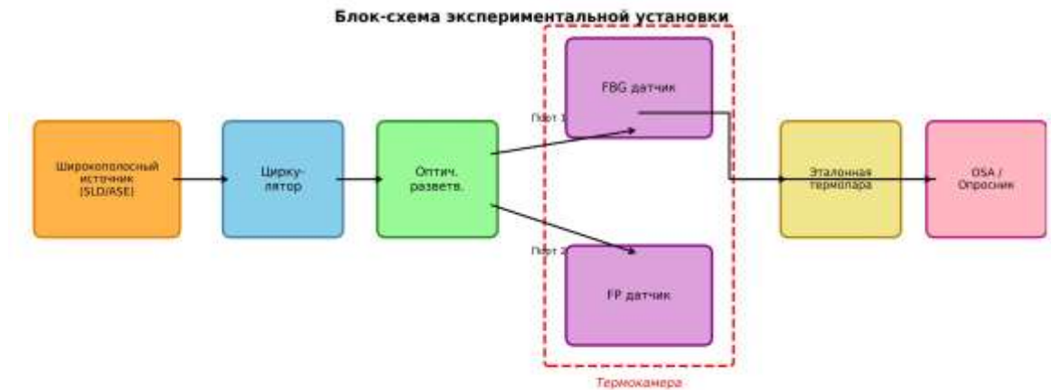
Рис. 5. Блок-схема экспериментальной установки для сравнительного исследования FBG и FP датчиков
