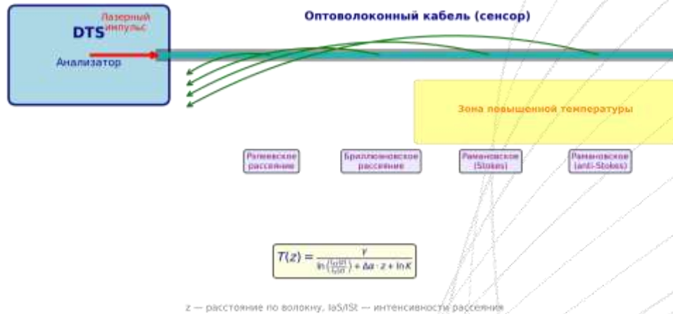
Рис. 3. Принцип работы DTS-системы
